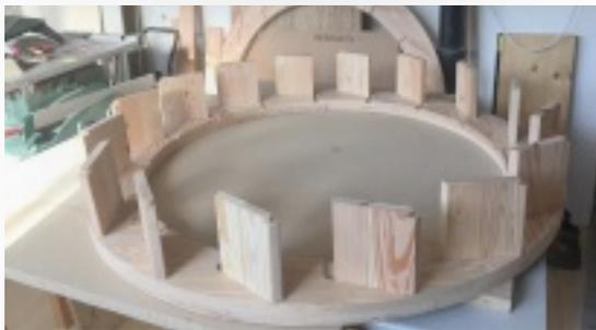
Einsetzen der Schaufeln in den Radkranz.
