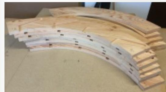
Die 16 Segmente liegen zum Verleimen bereit. Je ein innerer und äußerer Teil werden um 45 Grad versetzt verleimt.
