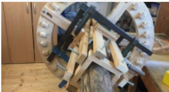
Für den exakten Rundlauf baue ich eine aufwändige Lehre. Mittels 16 Schrauben kann der Rundlauf eingestellt werden. Nun können alle 16 Eichenkeile vorsichtig eingeschlagen werden.
