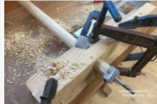
Selbstgebaute Vorrichtung, um aus den achteckigen Stecken runde mit exakt 36 mm Durchmesser zu machen. Die Handbohrmaschine dreht, das Hobeisen macht aus dem Achteck einen Rundstab.
