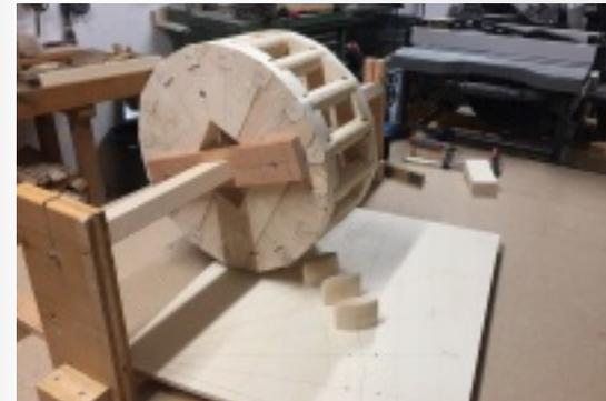
Vorrichtung zum Testen, ob die Stöcke und die Kämmen ineinander passen. Die Sperrholzplatte mit den aufgesetzten Kämmen liegt auf kleinen Rollen und ist drehbar.
