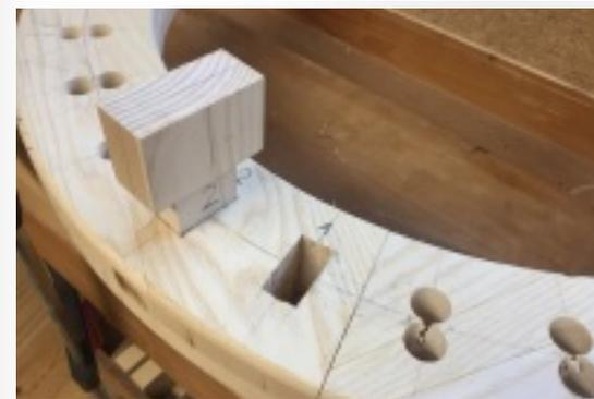
Ein Rohling eines Kammes (Zahnes) wird zur Probe eingesteckt. Er muss genau passen, darf keine Luft haben, sonst lockert er sich später.
