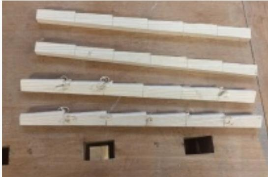
Die Sicherungskeile werden hergestellt. Weil jeder nur 5 cm lang ist, werden 30 cm lange Stücke für das Formen der Rundung (oben schräg) hergestellt und erst am Schluss abgelängt.
