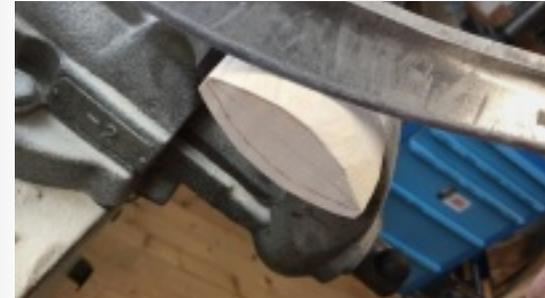
Mit dem Ziehmesser wird die zweite Rundung grob vorbereitet. Nachgearbeitet wird mit der Feile.
