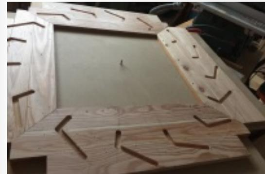
Alle Nuten sind eingefräst. Als nächstes werden dann die Rundungen auf der Bandsäge ausgesägt.
