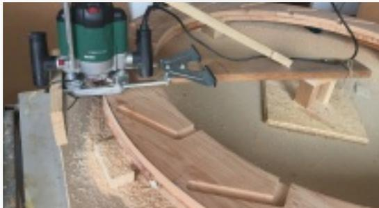
Selbstgebaute Vorrichtung zum Fräsen der Kränze innen und aussen.
