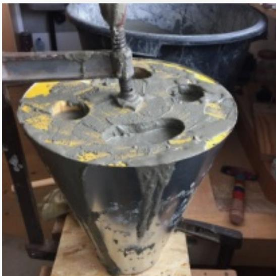
Es darf sich beim Betonieren nichts verschieben, denn um eine kompakte Füllung zu erreichen, muss vibriert werden (mit dem Kunststoffhammer an die Schalung klopfen).
