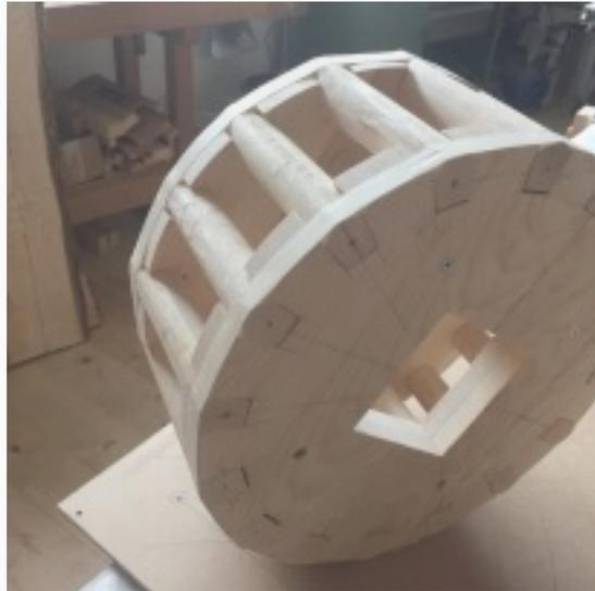
Die 16 Stöcke sind in den konischen Aussparungen fixiert. So lassen sie sich nicht verdrehen und sitzen unverrückbar fest. 2 Schrauben sichern die Stöcke. An Stelle des Klebbandes werden zum Schluss noch 2 Eisenringe das Stockrad umspannen.
