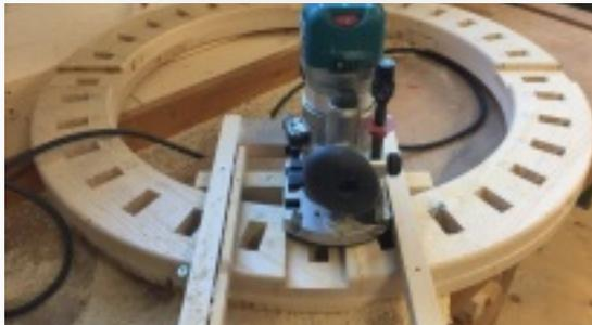
Die vier Ausfräsungen für die Radarme werden mit einer Lehre genau auf das Radzentrum ausgerichtet.
