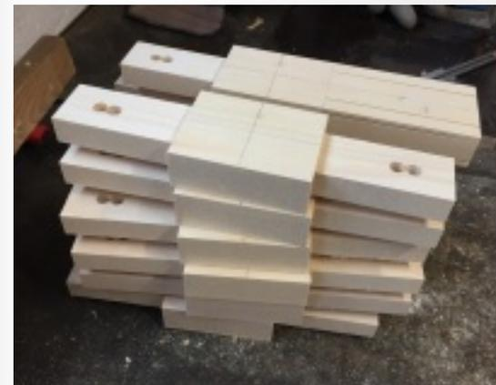
Bis jetzt erfolgten etwa zehn Arbeitsschritte. Der Kamm Nr. 4 ist länger, weil er durch einen Arm gehen muss. Der Schlitz, resp. die beiden Löcher fehlen noch. Dieses Mass kann erst am fertigen Kammrad bestimmt werden.
