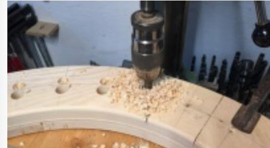
Aus 64 runden Löchern entstehen später mit dem Stemmeisen 32 rechteckige Löcher zum Durchstecken der Kämme.
