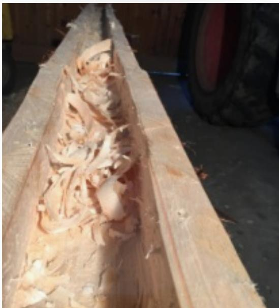
Im eigenen Wald suche ich eine schön gewachsene Tanne mit wenig Ästen aus. Mit der Motorsäge wird zuerst die Wasserrinne grob ausgesägt. Anschliessend wird mit dem Hohldekel, einer speziellen Axtform, ausgehöhlt. Das gibt bei 6 Meter Länge viele Späne (und Arbeit). Es gäbe natürlich moderne Methoden mit Fräsern, aber ich will das alte Handwerk ausüben.
