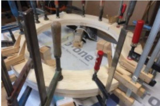
Verleimen der Segmente für das Kammrad. Alle verfügbaren Schraubzwingen sind im Einsatz!
