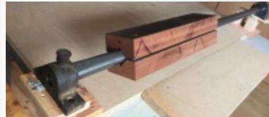
Der zweiteilige Wellbaum wird auf die durchgehende Welle geklemmt. Auf der runden Welle aufgeschweisste Flacheisen dienen als Mitnehmer.
