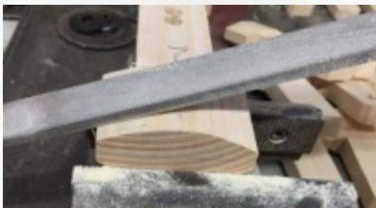
Mit der Feile wird eine der beiden Rundungen gemacht.
