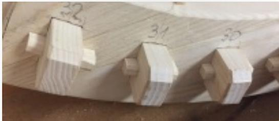
Die kurzen Keile sichern die Käbme. Üblicherweise werden die Keile um 90° versetzt durch den Kamm angeordnet, damit sie gut eingeschlagen werden können.
