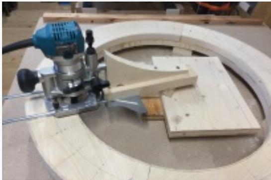
Vorrichtung zum exakten Fräsen des Innen- und Aussenkreises.
