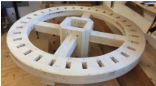
Die Radarme passen in die Ausfräsungen!
